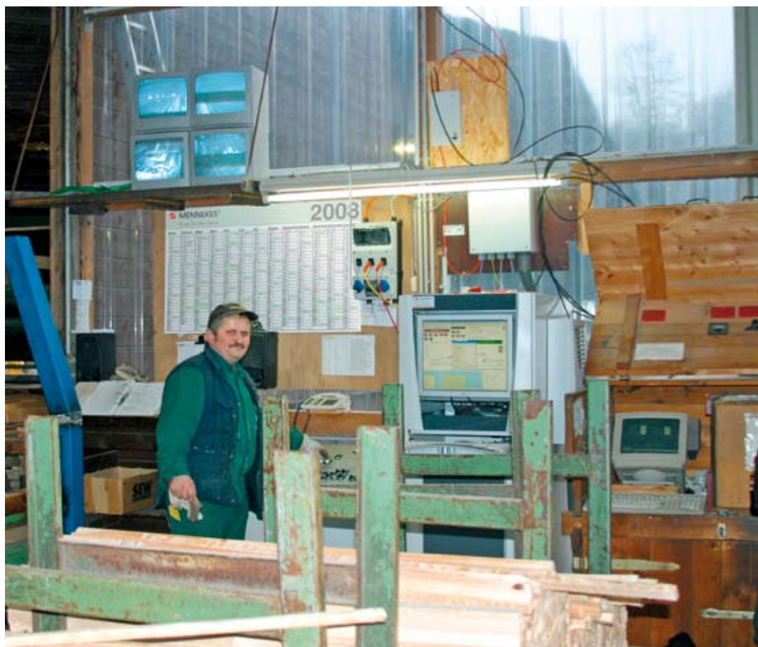
Сетевые корпуса АМАХХ® для надежной установки на участках с повышенным пылеобразованием
